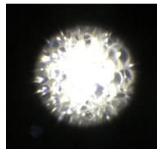
顕微鏡で見た水溶性片栗粉 (ダイラタンシー流体)
