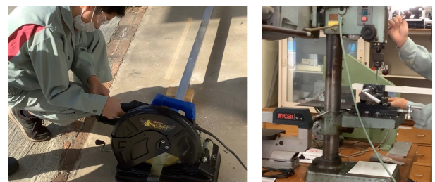
写真 6-1 モータ取付けベース加工の様子
